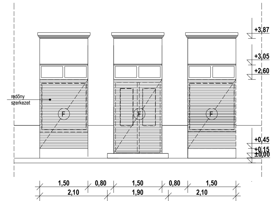
meglévő homlokzati portál redőny szerkezet nézetrajza
