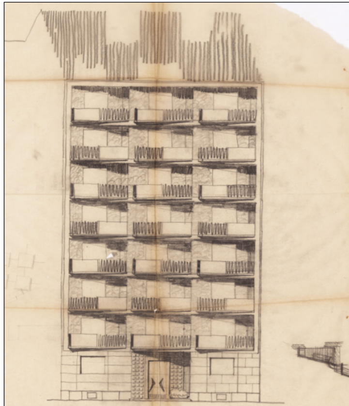
A főhomlokzat kézi vázlata abból az 1958-as tervcsoomaggól, amikor még a középtengelyben lett volna a főbejárat (Forrás: ÉKM-Lechner).
