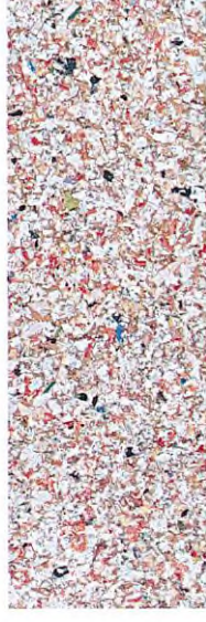
61. ábra - újrahasznosított műanyag hulladékból készülő "ecopanel"
